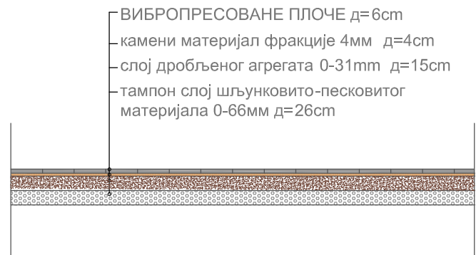
ПРЕСЕК ПОПЛОЧАВАЊА ТРОТОАРА У ЂУШИНОЈ УЛИЦИ
