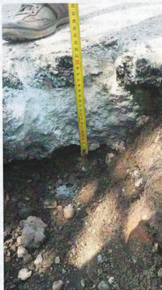
Slika 3: Istražna jama uz cevasti propust Ø600 - slojevi, u ulici Doža Đerđa
